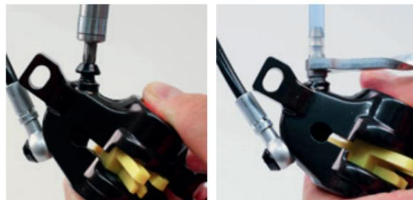
Befüllschraube öffnen und befüllte Spritze mit Befüllstutzen an Öffnung montieren.
