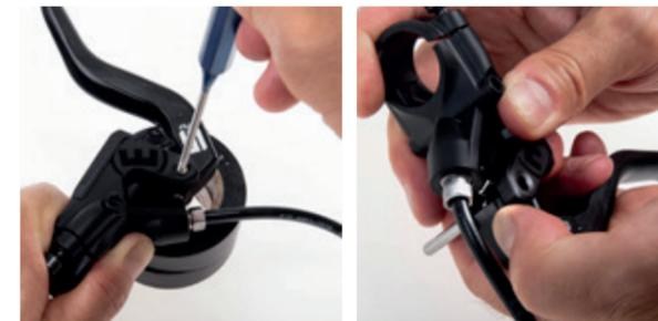
Nun mit einem Durchschlag mit max. 3,5 mm Durchmesser den Hebellagerstift vorsichtig ausschlagen (Hebellagerstift muss nicht komplett entfernt werden, ca. 2 mm können im Gehäuse verbleiben) und den Hebel entfernen.
