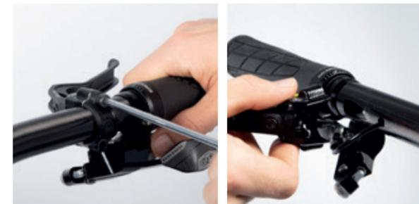
Beide Schrauben mit einem Torx T25 lösen und Klemmschelle abnehmen.
