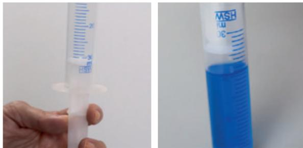
Verwende die Spritze mit Loch und befülle sie mit 20 ml Öl und einem Luftpolster von 5 ml. Presse die Spritze mit dem Konus in die EBT-Öffnung.
