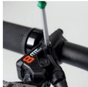
Bevor du startest, drehe den Bremsgriff in die waagrechte Position, damit die EBT-Öffnung der höchste Punkt ist.
