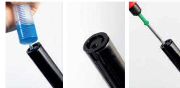
Jetzt das Loch mit dem Finger abdecken und Spritze vorsichtig abziehen. Nach dem Abziehen der Spritze oder des Profientlüftungskits, kurz nochmal Öl nachdrücken, bis es an der Öffnung ansteht.
