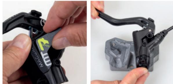
Jetzt das Cover auf beiden Seiten entfernen und den Bremsgriff auf das MAGURA Hebelwerkzeug oder ein Objekt mit Loch legen (z.B. eine Klebebandrolle).
