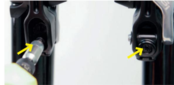
Befestigungsschraube mit **6 Nm** festziehen.
