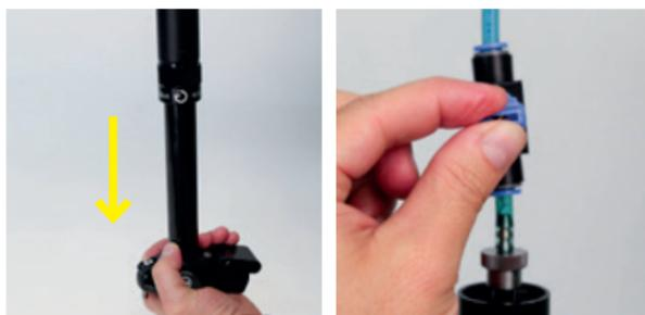
Sobald keine Luft mehr aufsteigt, ziehst du die VYRON ganz nach unten und verschließt das Befüllkit am Absperrhahn.
