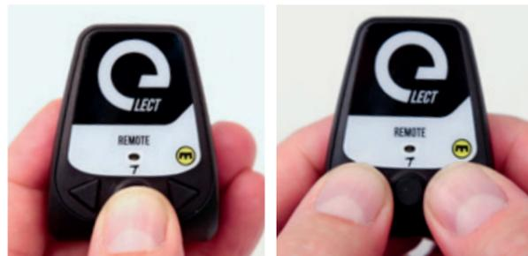
Die Remote, falls noch nicht geschehen, durch Drücken des mittleren Knopfes aufwecken. Nun beide Pfeiltasten solange gedrückt halten, bis LED konstant leuchtet. Dann loslassen und die LED beginnt zu blinken.
