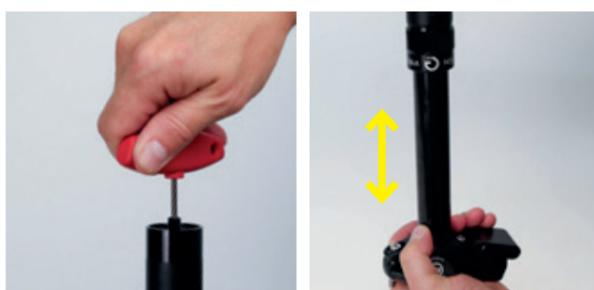
Nimm den 3 mm Inbus und schließe das Befüllventil.
