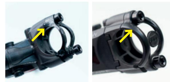
Bremsgriff kann links und rechts montiert werden. Daher bitte auf die richtige Montage der Klemmschelle achten.
