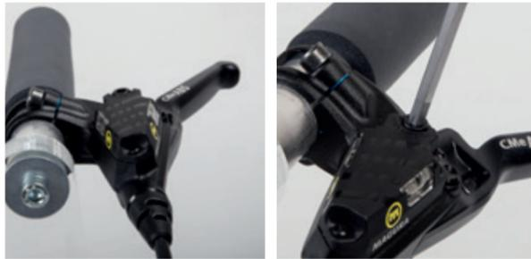
Drehe den Bremsgriff nach oben in die waagerechte Position, damit die EBT-Öffnung der höchste Punkt ist und der Ausgleichsbehälter waagrecht steht.
