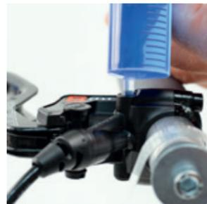
Verwende die Spritze mit Loch und befülle sie mit 20 ml Öl und einem Luftpolster von 5 ml.
