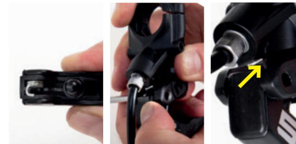
Anschließend den Bremsgriff waagrecht drehen und auf den neuen Hebel setzen.
