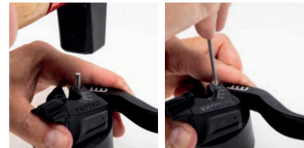
Anschließend den Bremsgriff mit Hebel auf rechts umdrehen und den Hebellagerstift nun wieder vorsichtig einschlagen. Zuletzt mit einem Durchschlag, bis er bündig abschließt.
