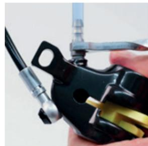
Befüllschraube öffnen und befüllte Spritze mit Befüllstutzen an Öffnung montieren.
