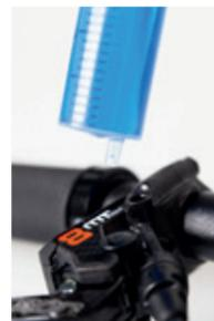
Im letzten Schritt ziehst du die Spritze bis knapp über das Loch auf. Nun noch einmal kurz auf die Spritze drücken und anschließend wieder über das Loch aufziehen. Kurz warten bis der Ölstand sich gesenkt hat.
