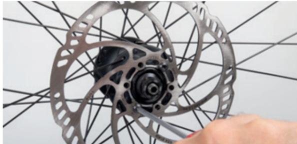
Richtungsangabe auf Bremsscheibe beachten und die Schrauben über Kreuz mit dem angegebenen Drehmoment festziehen.
