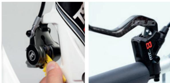
Vor dem Leitungskürzen die Kolben vorsichtig zurückdrücken, idealerweise mittels Transportsicherung, alternativ mit Schraubendreher.
