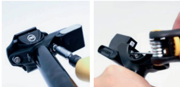
Sattelklemmung durch Lösen der zwei T25 Schrauben abnehmen.
