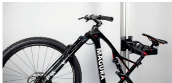
Fahrrad in Montageständer so fixieren, dass Lenker deutlich höher positioniert ist.
