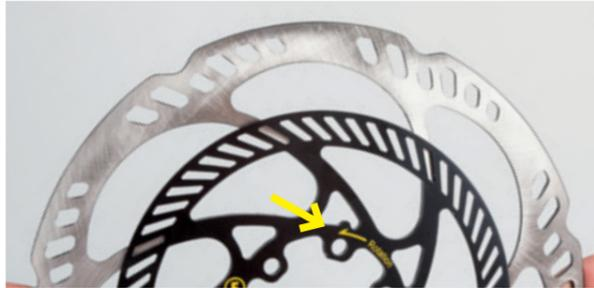
Verwende die Storm HC oder MDR-C in 180 mm für das Bosch ABS System.
