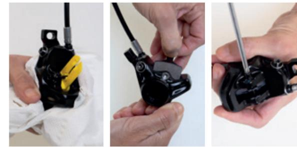
Bremse reinigen und anschließend Transportsicherung entfernen.
