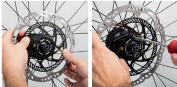
Drehe vor dem Anziehen die Bremsscheibe mit dem Sensorring im Uhrzeigersinn auf der Nabe. Dadurch wird die Bremsscheibe auf der Nabe zentriert.
