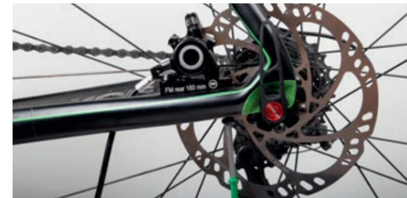
Bremszange ausrichten und anschrauben.
