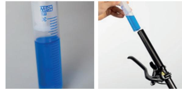
Verwende die Spritze mit Loch und befülle sie mit 20 ml Öl und einem Luftpilster von 5 ml.
