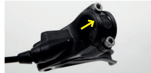
Bremsgriff kann links und rechts montiert werden. Daher bitte auf die richtige Montage der Klemmschelle achten (Pfeil zeigt nach oben).
