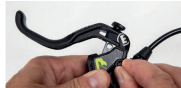
Entferne zunächst den BAT Adjuster bzw. Blende. Dazu den Verschluss nach unten drücken und um 90° drehen.
