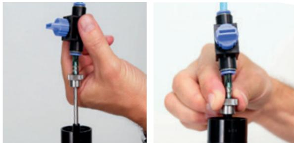
Steck das Befüllkit durch die Ventilbohrung.
