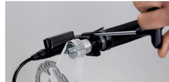
Anschließend Bremsgriff in gewünschte Position drehen und zuerst obere Schraube mit **4 Nm** dann untere Schraube mit **4 Nm** anziehen.
