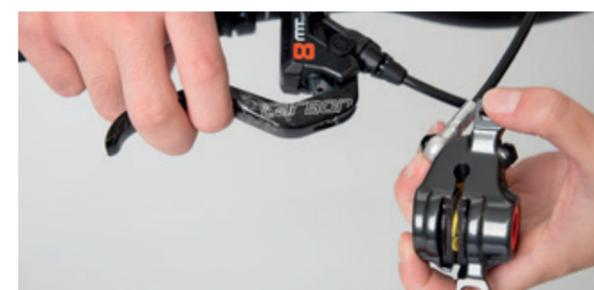
Anschließend Transportsicherung einsetzen oder Bremse montieren.
