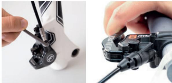
Nach dem Verlegen muss die Bremse auf Funktion und Dichtigkeit überprüft werden. Betätige dazu den Bremshebel.
