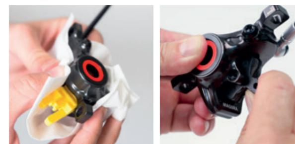
Bremse reinigen und anschließend Transportsicherung entfernen.
