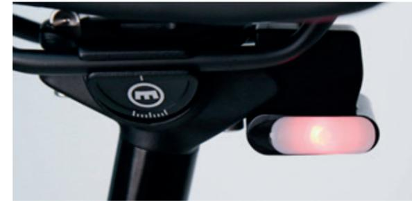
Nun leuchtet die VYRON eLECT Einheit und die Remote blinkt. Sobald das Verbinden abgeschlossen ist, blinkt die VYRON eLECT Einheit 2 – 4 mal und die Remote blinkt grün.
