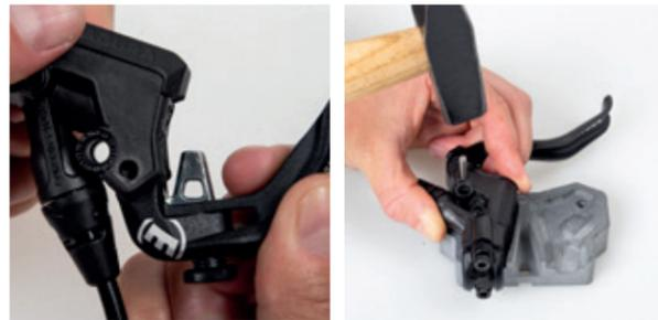
Den neuen Hebel einsetzen und so positionieren, dass die Öffnungen übereinander liegen.
