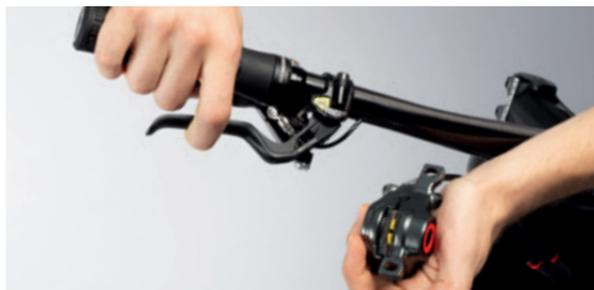
Zuletzt das System komplett mit Öl befüllen.
