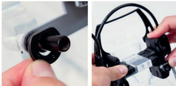
Montiere zuerst die abgeflachte Unterlegscheibe mit der flachen Seite nach oben. Dann die Montageplatte auf die Canti-Bolzen schieben.
