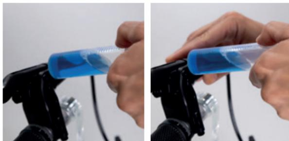
Im letzten Schritt ziehst du die Spritze bis knapp über das Loch auf. Nun noch einmal kurz auf die Spritze drücken und anschließend wieder über das Loch aufziehen. Kurz warten bis der Ölstand sich gesenkt hat.
