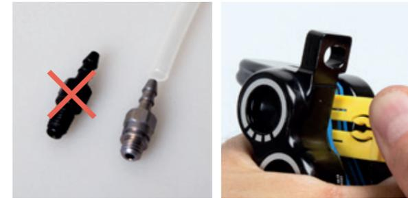
**Achtung: Kurzen Befüllstutzen verwenden!**
