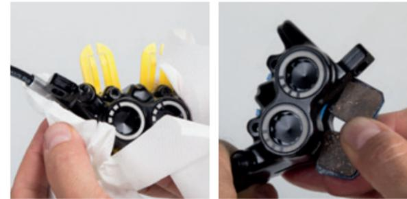
Bremse reinigen und anschließend Transportsicherung entfernen.
