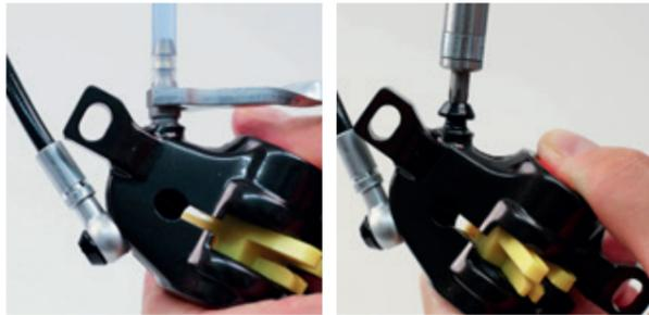
Jetzt die Zange auf gleiche Höhe wie den Bremsgriff halten. Dann Befüllstutzen an Zange abnehmen und verschließen.
