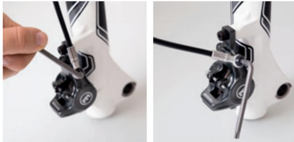
Öffne den Leitungsanschluss mit einem Torx T25 um max. 30° gegen den Uhrzeigersinn.
