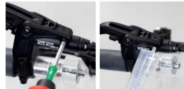
Dann EBT-Schraube mit Torx T25 entfernen.
