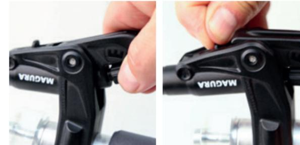
Belagverschleißnachstellung ganz zurück drehen (HS22) bzw. schrauben (HS11).
