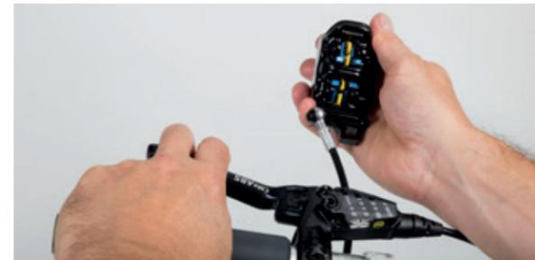
ABS Box nach hinten drehen in Ausgangsposition 0 – 10 Grad. Schrauben auf beiden Seiten der ABS Box mit **0,5 Nm** anziehen.
