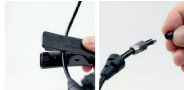
Nimm die Leitung nach dem Verlegen durch den Rahmen und kürze diese auf die richtige Länge.
