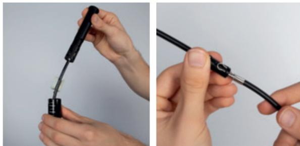
Zum erneuten Einsetzen einfach die Hydraulikeinheit in das Lenkerende schieben.
