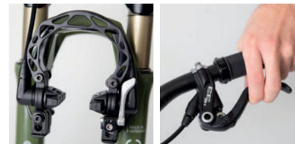
Belag an Felge schleiffrei einstellen (so knapp wie möglich, max. 0,5 mm Abstand). Anschließend eine Seite fixieren und dann Bremshebel vorsichtig betätigen.
