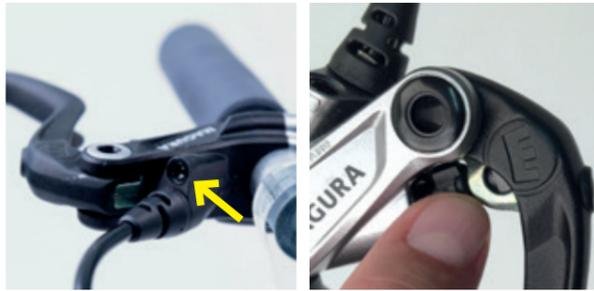
Bremsgriff waagrecht ausrichten und darauf achten, dass die EBT-Schraube oben ist.
