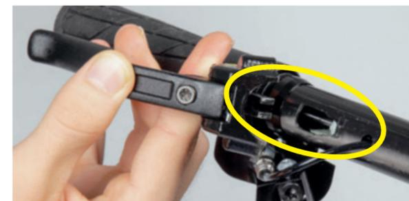
Beim erneuten Einsetzen der Hebeleinheit darauf achten, dass beide Nasen über die Kolbenstange geführt werden und sauber in dem Kunststoffteil eingesetzt sind.
