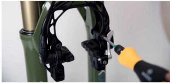
Anschließend EVO2 Adapter festschrauben.
