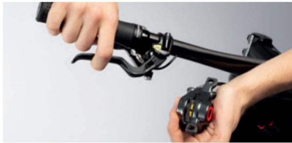
Anschließend Transportsicherung einsetzen oder Bremse montieren.
