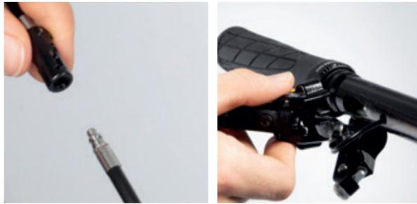
Vorbau lösen und vom Steuerrohr vorsichtig abnehmen, bis Easy Link tube Kupplung zu sehen ist (siehe 4.3). Trenne zuerst die Leitung an der Easy Link tube Kupplung (siehe 4.3).
