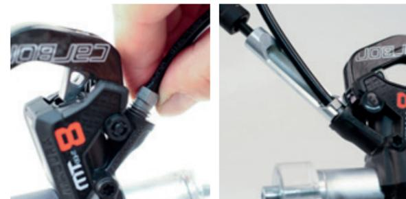
Dann die neue Leitung mit der Überwurfschraube erst von Hand eindrehen. Achte darauf, dass die Leitung bis auf auf Anschlag im Gebergehäuse steckt.
