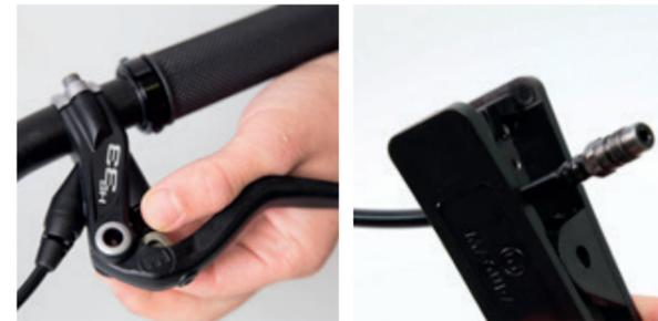
Zuerst die Einstellschraube am Bremsgriff zurückdrehen. Zudem Griffweiteneinstellung ganz zurück-schieben (nur bei HS22). Anschließend die Leitung am Nehmer kurz abschneiden.
