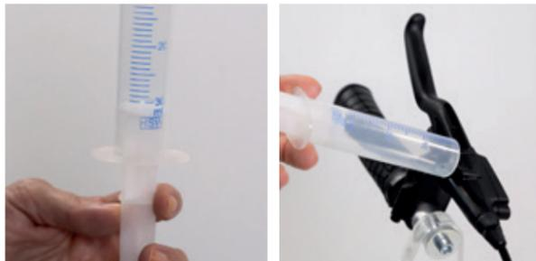
Setze nun die leere Spritze mit Loch ein (zuvor den Kolben über das Loch ziehen) oder verwende das Profientlüftungskit.
