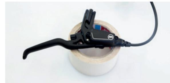
Bremsgriff auf ein Objekt mit Loch legen (z. B. eine Klebebandrolle).
