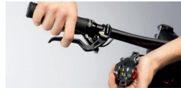
Zuletzt Bremse auf Dichtigkeit und Funktion prüfen.
