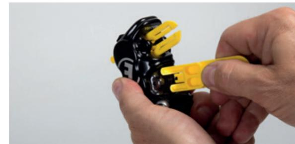
Schiebe nun die Transportsicherung mit der dicken Seite zwischen die Kolben.
