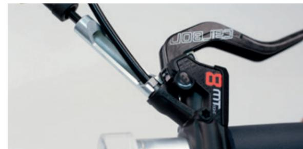
Entferne die alte Leitung mit einem 8er Gabelschlüssel.
