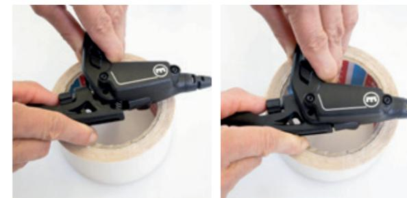
Anschließend neuen Hebel einsetzen. Hierbei auf korrekte Position, Sitz der Feder und Flucht der Bohrung achten.
