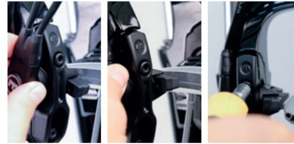
Nachdem der Abstand eingestellt wurde, kannst du durch verdrehen des Bremszylinders die Position zur Felge einstellen.
