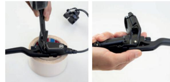
Nun Hebellagerstift von oben einsetzen und mit einem Durchschlag mit max. 3,5 mm Durchmesser vorsichtig einschlagen bis er bündig mit der Gehäuseunterseite abschließt.
