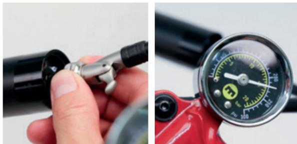
Ventilkappe abnehmen und Pumpe ansetzen. Dann mit mindestens 10 Bar befüllen.
