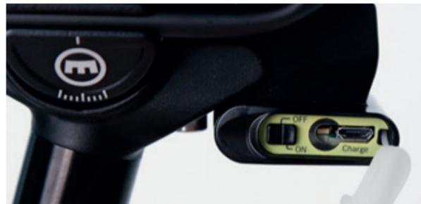
VYRON eLECT Einheit einschalten und sicherstellen, dass der Akku geladen ist.
