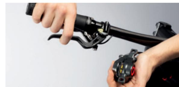
Zuletzt Bremse auf Dichtigkeit und Funktion prüfen.
