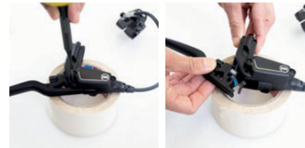
Nun mit einem Durchschlag mit max. 3,5 mm Durchmesser den Hebellagerstift vorsichtig ausschlagen und den Hebel entnehmen.
