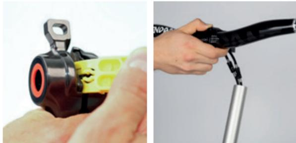
Kolben vorsichtig zurück drücken, idealerweise mittels Transportsicherung, alternativ mit Schraubendreher.
